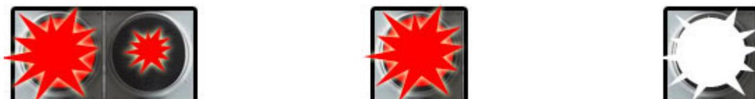
Такие светофоры применяют для регулирования движения через железнодорожные переезды. Светофоры с красными сигналами любых исполнений, кроме того, применяют для регулирования движения через разводные мосты и на причалах паромных переправ.
