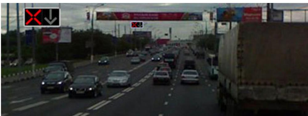
На этом участке дороги для реверсивного движения выделена только одна полоса. И сейчас на реверсивном светофоре нам горит красный крест. И, следовательно, сейчас реверсивная полоса отдана водителям встречного направления.
