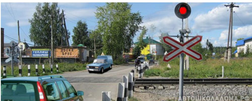
Это может быть либо один красный сигнал, мигающий с частотой раз в секунду.
