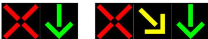
Реверсивные светофоры любых исполнений применяют для регулирования движения на отдельных полосах проезжей части при организации реверсивного движения.
